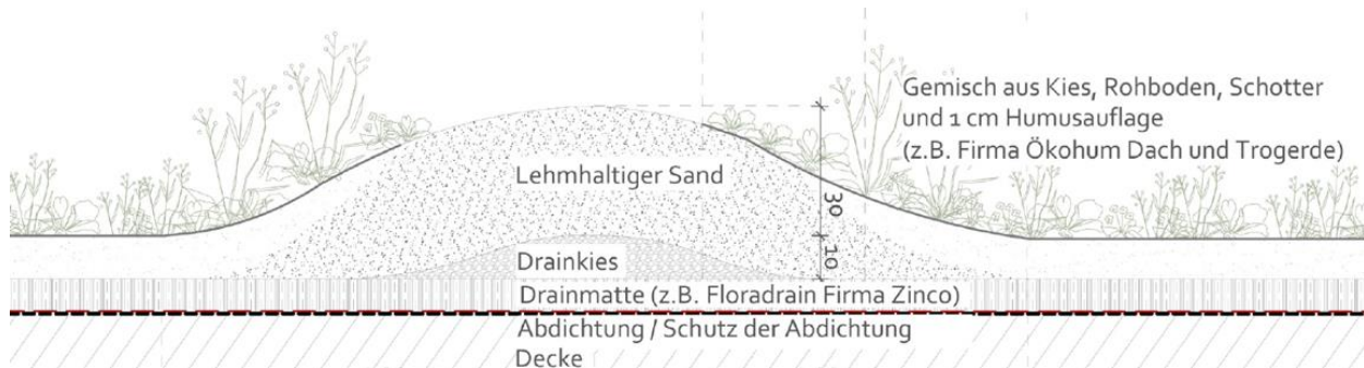
Abbildung 22: Aufbau eines Nisthügels, der vor allem porös sein soll und aus nährstoffarmem Substrat besteht © Stadt Zürich, Amt für Hochbauten
